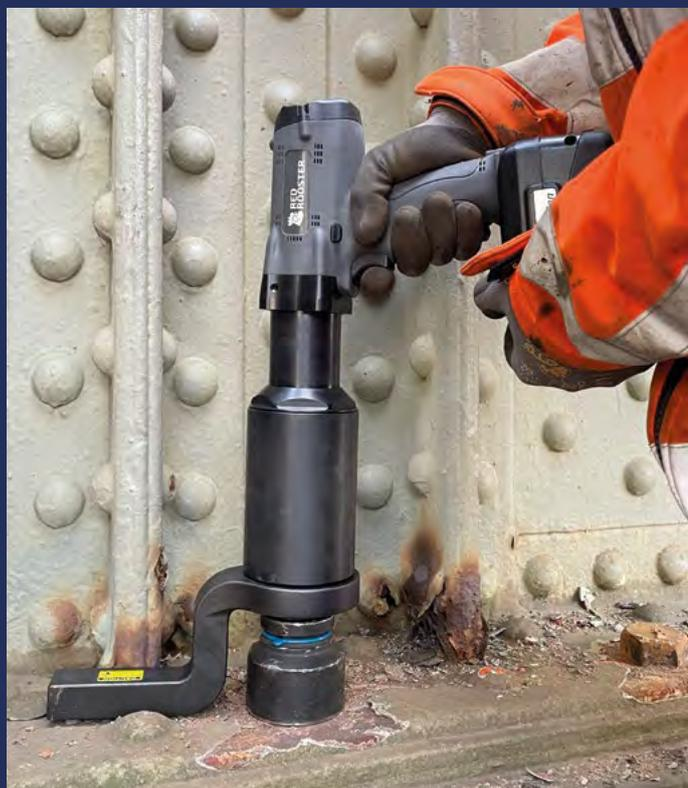
Red Rooster a développé une gamme de visseuses jusqu'à 2500 Nm. La facilité d'utilisation, la vitesse et la précision sont des caractéristiques essentielles. La série RRI-BEC a la vitesse la plus élevée de son segment. Le couple est facilement réglable grâce au display sur l'arrière.
