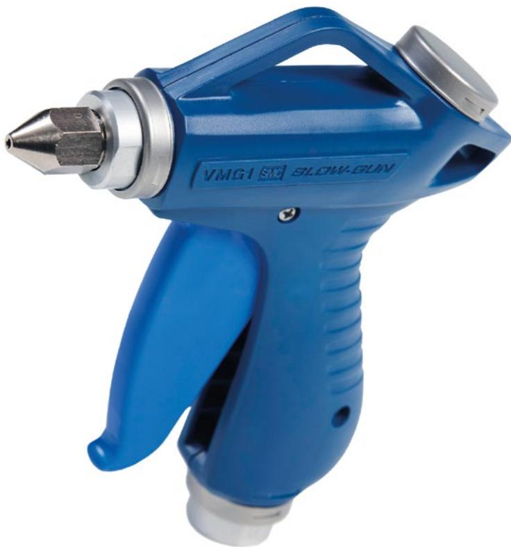
La série de soufflettes VMG a été spécialement développée pour offrir des performances de soufflage optimales avec une faible consommation d'air. Les soufflettes sont dotées d'une poignée ergonomique et d'une valve brevetée. Cette valve réduit la consommation d'énergie jusqu'à 20 % sans compromettre les performances.
