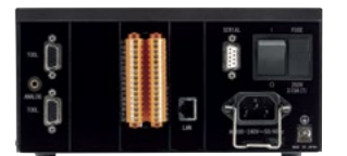
VUE ARRIÈRE 1. Connection Ethernet (option) 2. Bornier d'entrée-sortie 3. Connecteur de l'outil 1 4. Connecteur de l'outil 2
