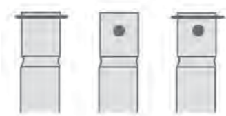
Type à jonc d'arrêt (standard) Type à trou Type à jonc d'arrêt et trou
