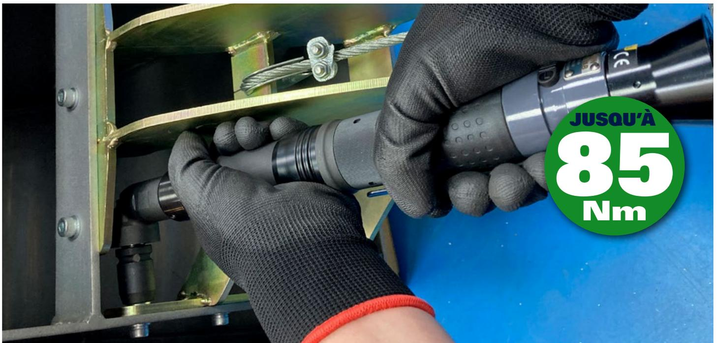
Les visseuses Red Rooster à coupure d'air automatique offrent une grande plage de couples de serrage et se distinguent par leur précision, leur ergonomie et leur faible niveau de vibration. Le design spécifique de l'embrayage combine des forces de faible réaction à une grande répétabilité du couple. Cet outil pneumatique est conçu pour l'industrie de l'assemblage.
