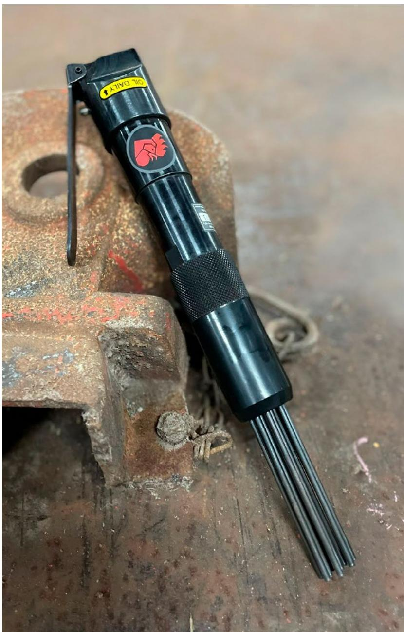
Le burineur à aiguilles léger Red Rooster offre des performances d'impact puissantes dans un design compact et ergonomique. Livraison standard avec 12 aiguilles de 3 mm.
